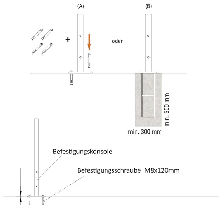
2. Stellen Sie sicher, dass die Löcher in den Pfosten über den Löchern in den Befestigungskonsolen liegen.
