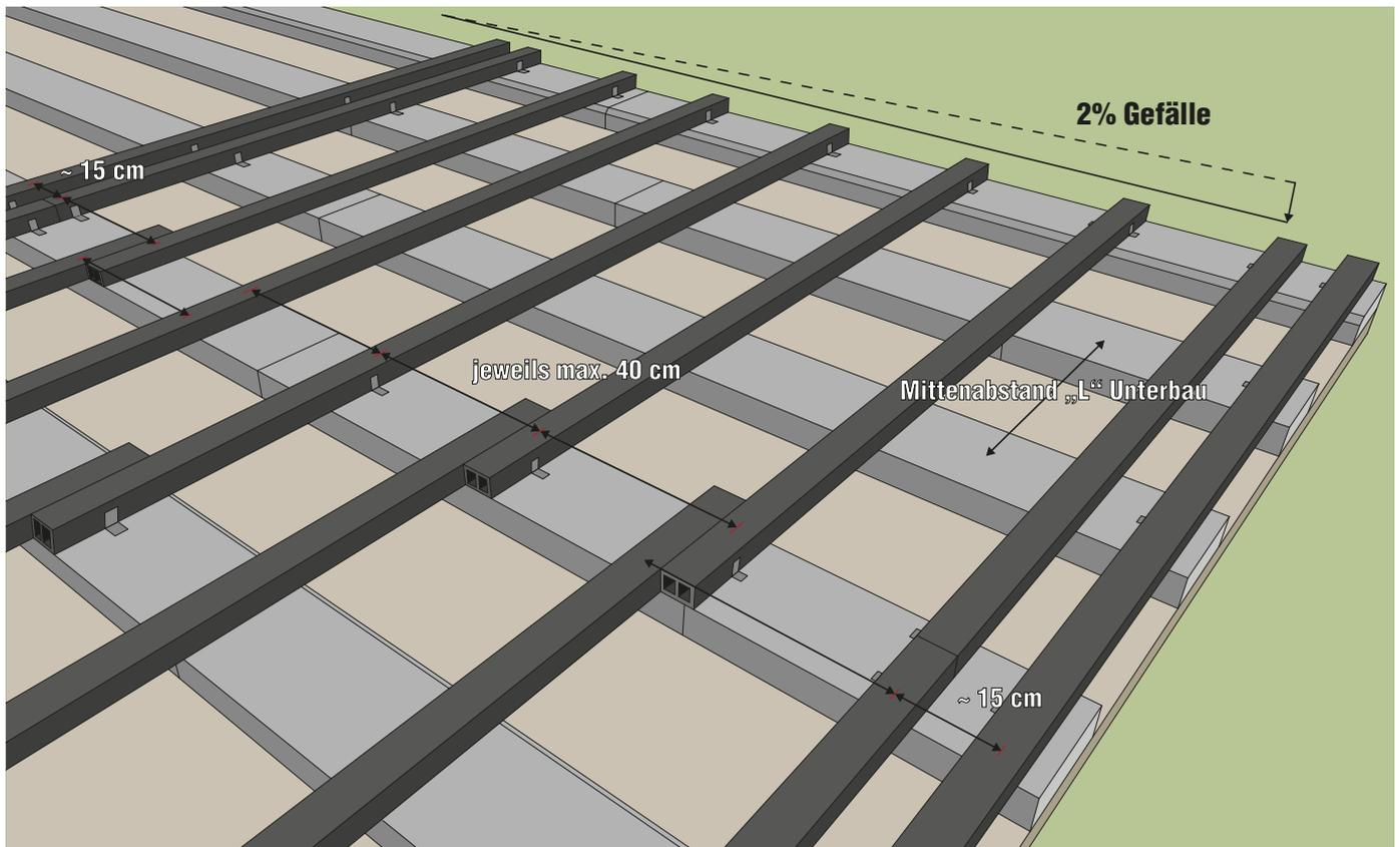
Abb. 2: Befestigung eines Dielenstoßes in der Fläche
