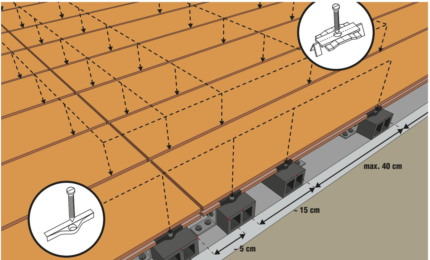
**Abb 4: Abschlussarbeiten (Kantenabschluss)**
