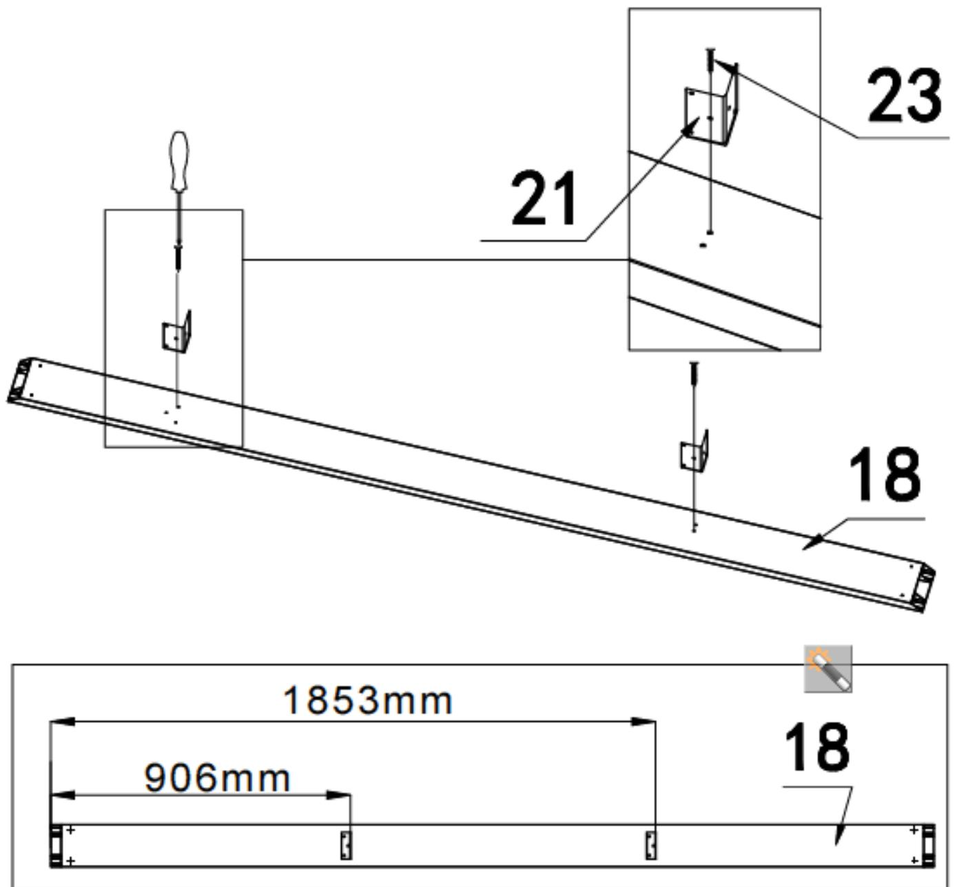
Fixieren Sie die Metallwinkel mit den beiliegenden Schrauben auf den Alublenden.
