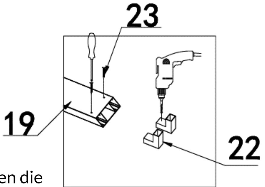
Als nächstes werden die Verbindungsstücke in die dafür vorgesehenen Löcher gesteckt. Bohren Sie danach die Löcher mithilfe eines Akkuschaubers.
