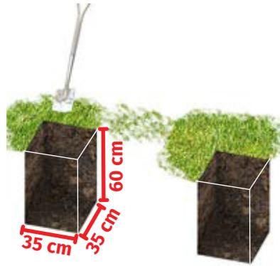
**Zum Einbetonieren (1):** Heben Sie mit genug Abstand die entsprechende Anzahl an Löchern für Ihre Zaunpfosten aus.
