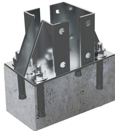
**Konsolle zum Aufschrauben:** Befestigen Sie die Dehnschrauben in den Beton. Platzieren Sie dann die Konsolle, wie im Bild, und fixieren Sie diese mit den Muttern.
