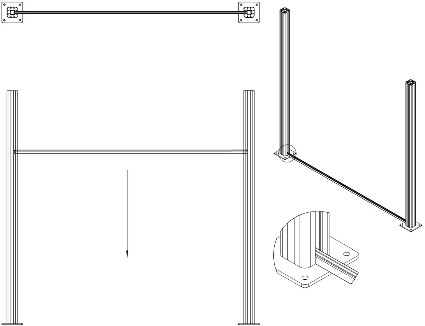
**4. Montiere die untere Aluminium-Abdeckung**
