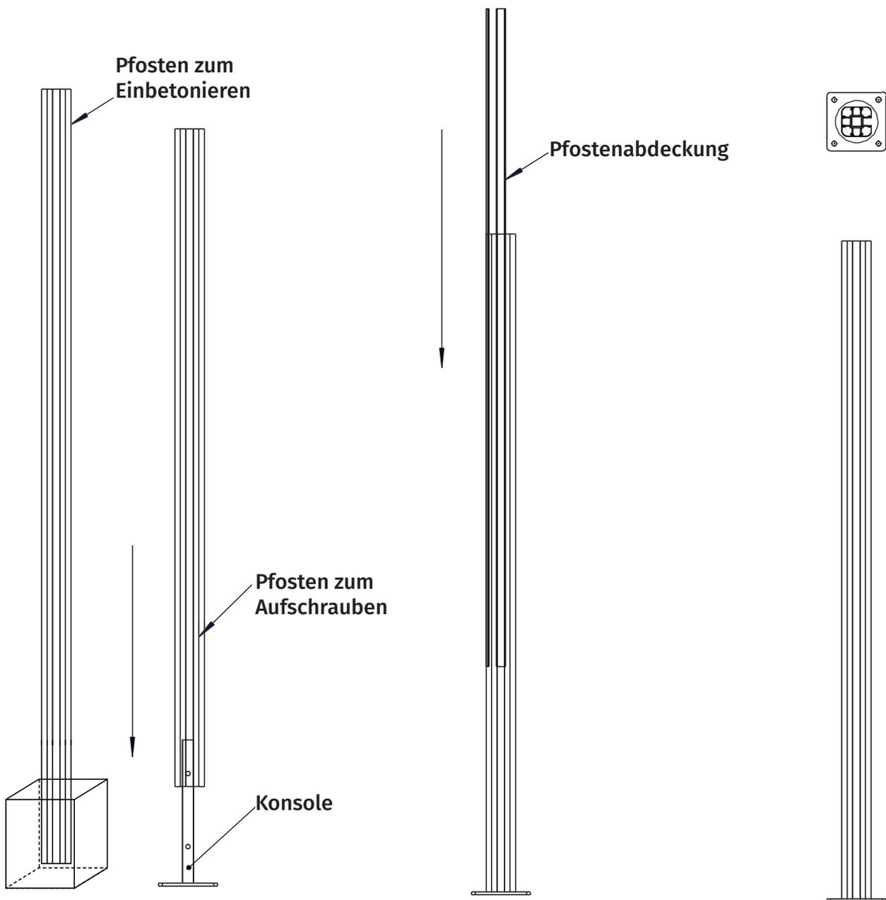
**1. Zum Aufschrauben:** Befestige erst die Konsole am Boden, dann den Pfosten auf der Konsole.
