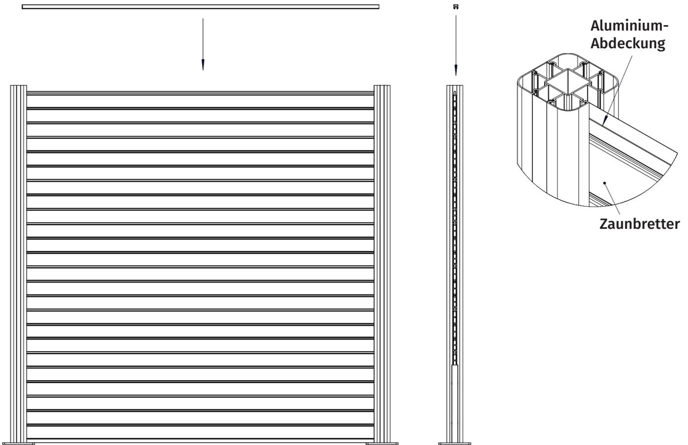
7. Zum Schluss wird die obere Aluminium-Abdeckung montiert.
