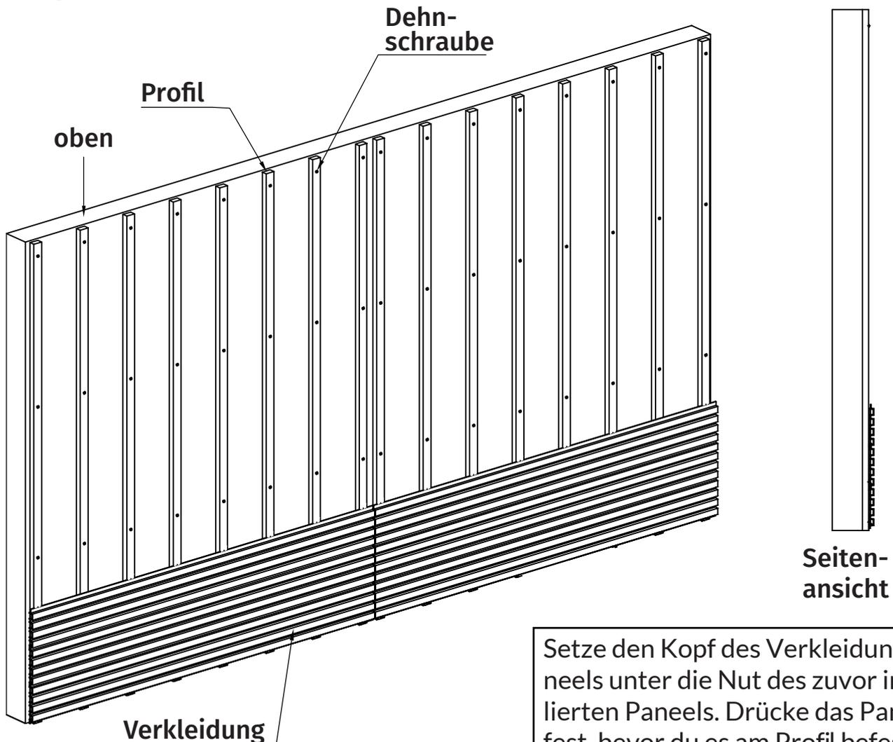
Setze den Kopf des Verkleidungspaneels unter die Nut des zuvor installierten Paneels. Drücke das Paneel fest, bevor du es am Profil befestigst.
