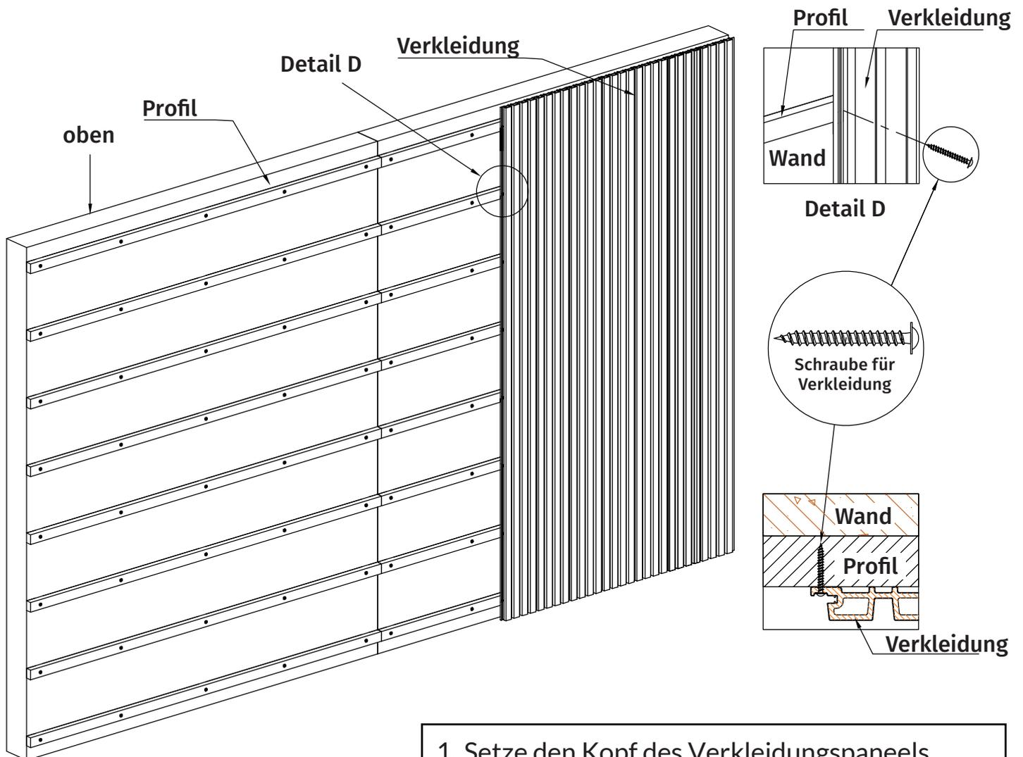
1. Setze den Kopf des Verkleidungspaneels unter den Schlitz des zuvor installierten Paneels. Drücke das Paneel fest, bevor du es am Profil befestigst.
