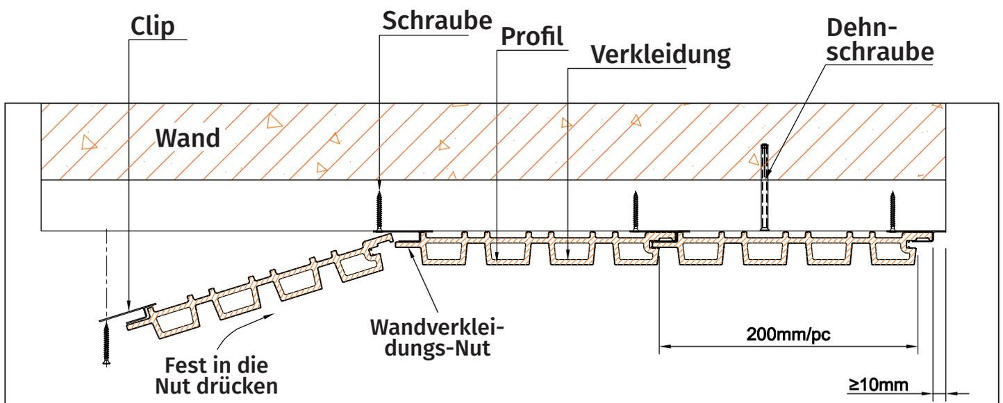
Unabhängig von der Ausrichtung deiner Paneele müssen zwei separate Profile an den Stellen vorhanden sein, an denen sich zwei Paneele Kopf an Kopf treffen. Verwende kein einzelnes Profil für beide Paneele. Es muss ein Abstand von 6 mm zwischen den Enden der Paneele eingehalten werden.
