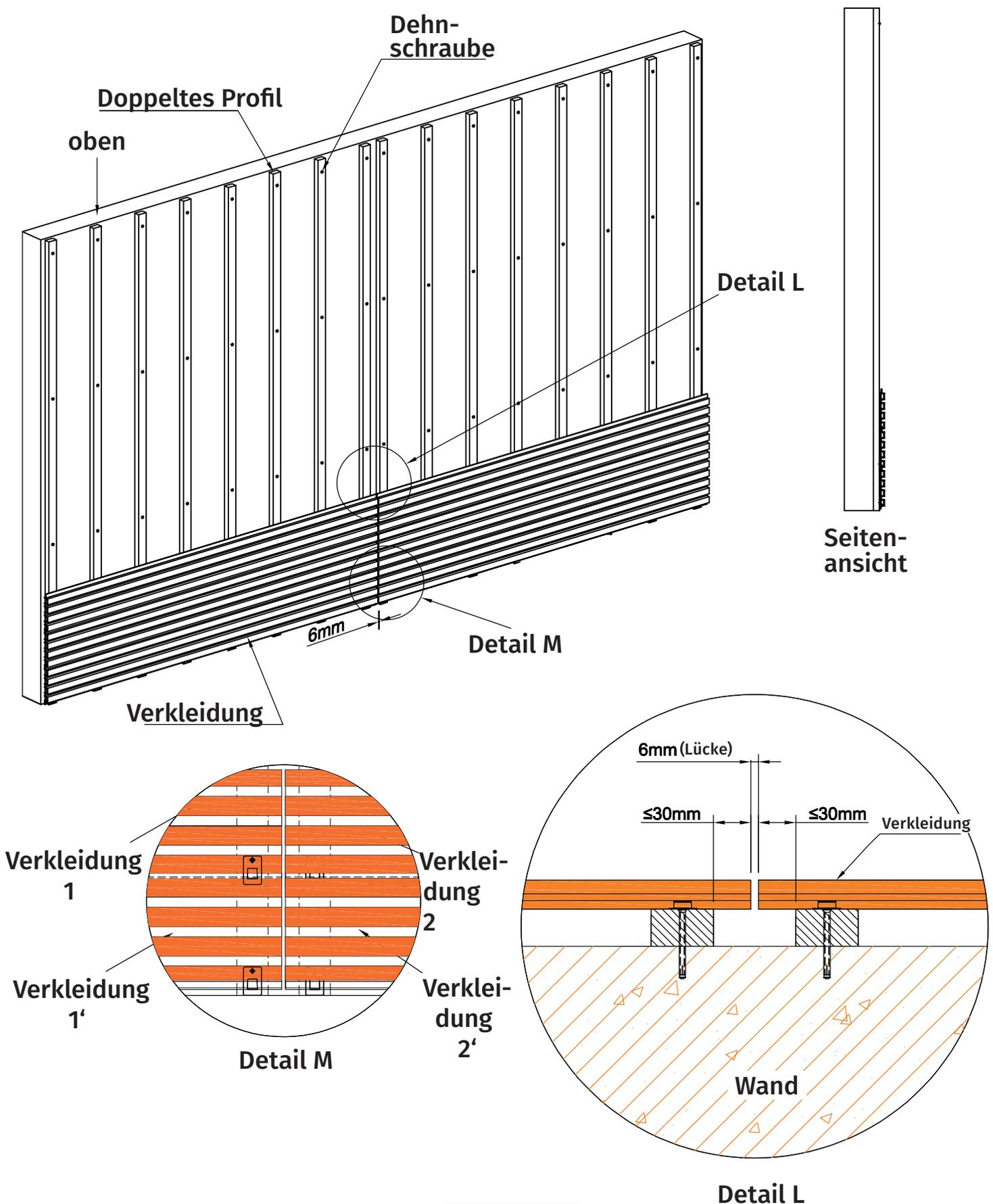
1. Die Enden aller Paneele müssen zur Sicherstellung der Stabilität auf den Profilen verschraubt werden.
