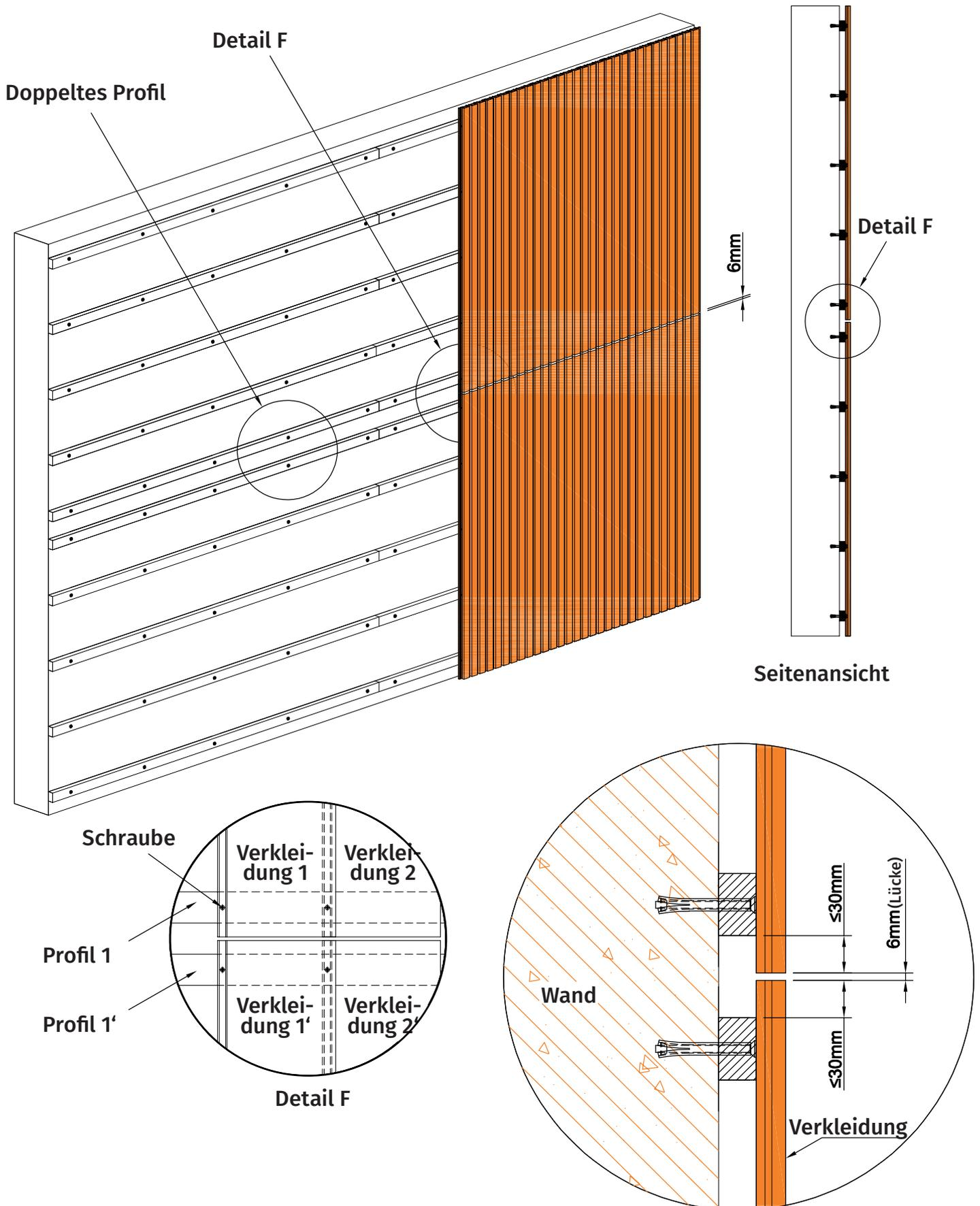
1. Alle Paneelköpfe müssen zur Sicherstellung der Stabilität auf den Profilen verschraubt werden.
