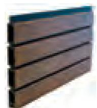
Coextrudierte WPC-Produkte sind mit einem Gemisch aus rund 70 Prozent Kunststoff und 30 Prozent Holz überzogen. Der Kern besteht wie bei klassischen WPC-Produkten aus rund 60 Prozent Holz und 40 Prozent Kunststoff. Der Überzug macht die Produkte noch widerstandsfähiger gegen Schmutz, Fette, Abnutzung, Witterungseinflüsse und Feuchtigkeit.
